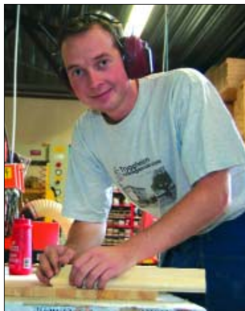
Mye av produksjonen foregår manuelt. Her pusser Kjell Erlend Gunnes ei gesimslist.
